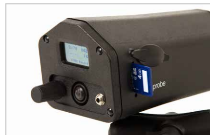
Los datos de lubricación pueden almacenarse en la tarjeta SD
