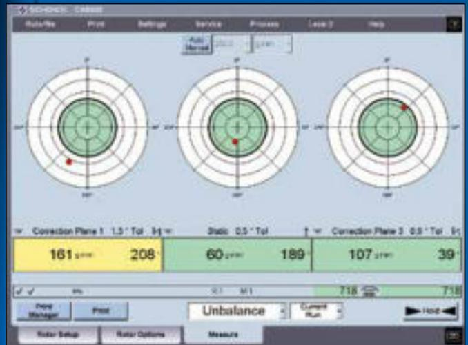
En rotores flexibles que deben medirse en 3 planos, el operador puede visualizar a primera vista la intensidad de desbalanceo y sus ángulos.
