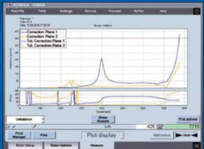
El efecto de desbalanceo de un rotor flexible se puede medir durante la fase de aceleración y representarse en un diagrama de Nyquist.
